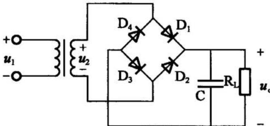
Figure10. Bridge rectifier circuit
