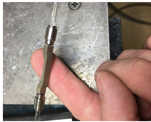
Abbildung 4.9: erster Prototyp fuer die Wasserkuehlung zweier eGaN-FETs (Bild wurde von der Firma IQ Evolution zur Verfuegung gestellt)
