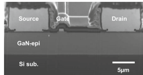
Abbildung 2.6: Querschnitt einer REMs Aufnahme eines GIT [7]
