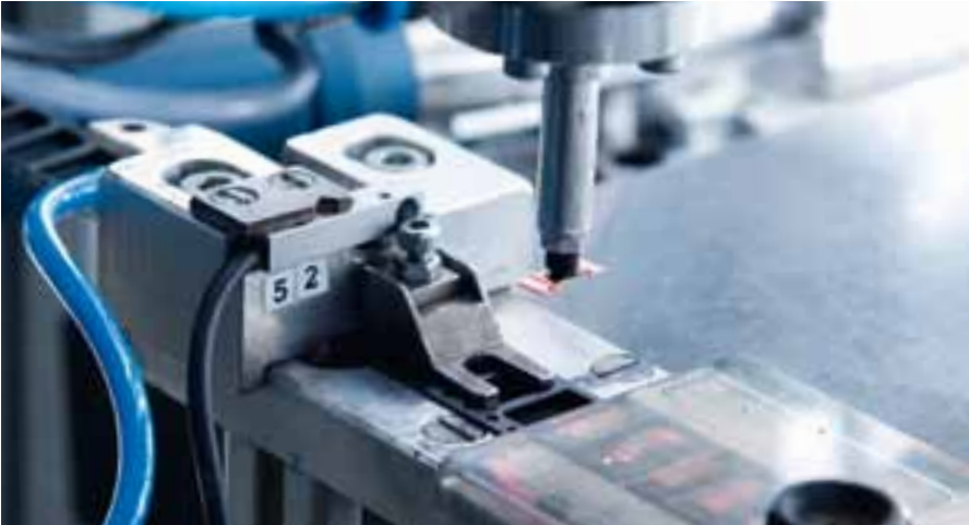
Vor der Verpackung in Standardgurte werden die Bauelemente umfangreich getestet, gemessen und abgeglichen
